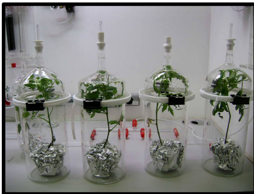
Figura 2: Sistema de aeração para coleta de voláteis contendo quatro cultivares comerciais de tomate, Solanum lycopersicon .
